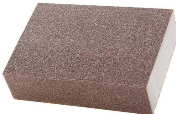
Durch den Einsatz von Schaumstoff als Trägermaterial unterscheiden sich gestreutes Korn und das erzielte Schliffbild. Wir geben daher an: Korn = gestreutes Korn und Schliffbild = entspricht ca. dem Ergebnis von Schleifpapier (z.B. Korn 100 = ca. P 220). Bitte prüfen Sie selbst. Ein geringer Kornausbruch ist normal. Werkstücke sind nach der Bearbeitung zu reinigen.
